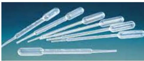
Une pipette compte-gouttes est un tube fin (quelques mm de diamètre) en matière plastique, généralement gradué, et possédant une extrémité fermée en forme de réservoir et l'autre extrémité ouverte avec un bout affiné en pointe. Elle est à usage unique (« en principe »).
