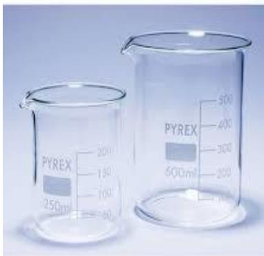
C'est un récipient à fond plat muni d'un bec verseur qui sert à contenir des liquides en vue de manipulation.
