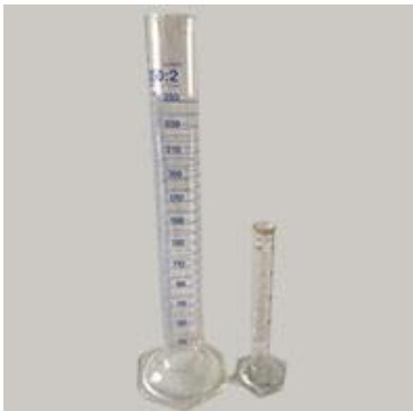
Une éprouvette est un **réceptif gradué**, long et relativement étroit, avec une base plate et large pour assurer sa stabilité en position verticale, et muni d'un bec verseur. Une éprouvette est généralement en verre, mais il en existe aussi en matière plastique.
