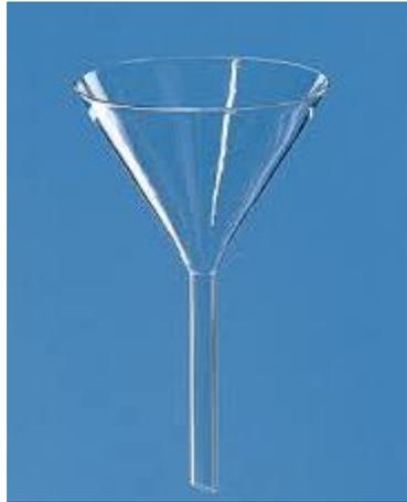
Un entonnoir est un ustensile évasé, conique et muni d'un col. Il existe des entonnoirs à liquide, d'autres à solide (ces derniers présentent des cols courts et très larges).
