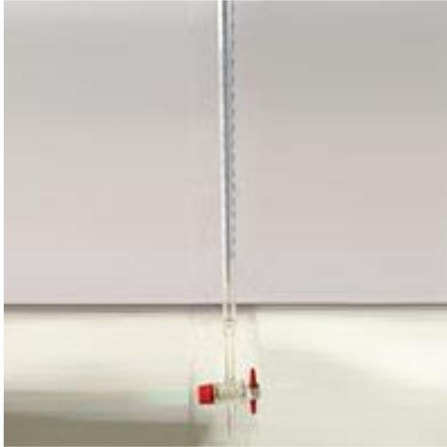
Une burette est un **réceptif gradué**, qui permet de délivrer un liquide avec un **volume donné précis**. De forme allongée et étroite, une burette présente en son extrémité basse un robinet (qui permet de stopper ou moduler le débit de liquide délivré – il est en verre ou en téflon) et en son extrémité haute une ouverture un peu évasée (pour faciliter son remplissage).
