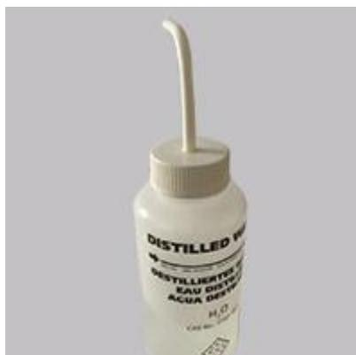
Une pissette est un récipient en matière plastique, muni d'un tube plongeur, d'un tube verseur recourbé, et d'un bouchon vissé pour assurer une fermeture étanche.
