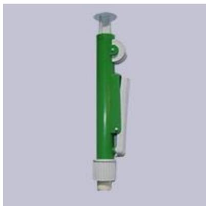
Un pipeteur est un système de pipette en matière plastique, qui fonctionne sur la base d'une pompe à crémaillère.
