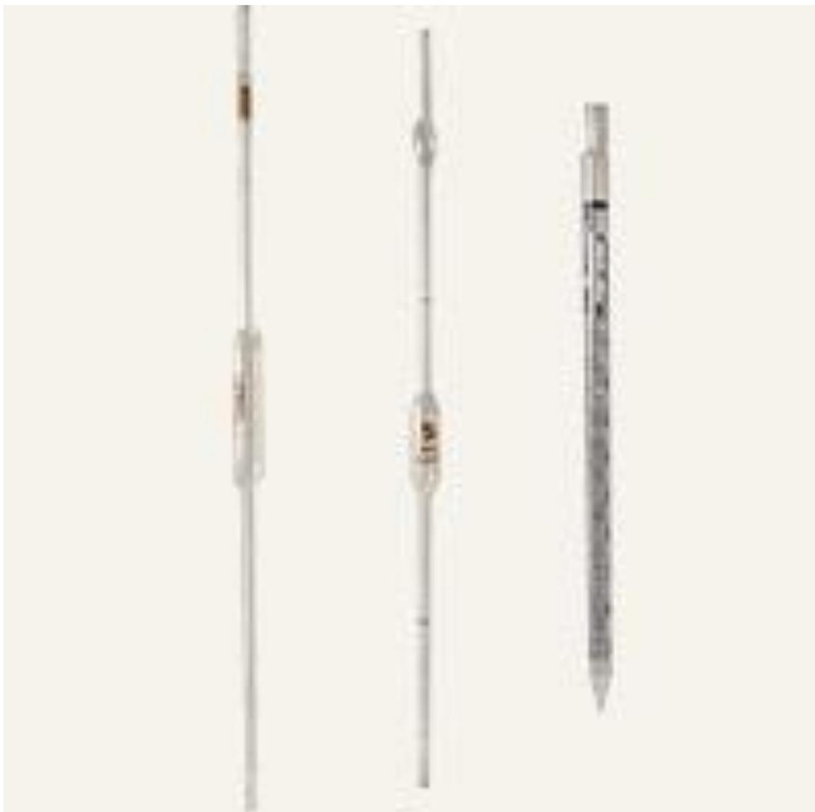
Il existe deux types de pipettes en verre : les pipettes graduées, et les pipettes jaugées.
