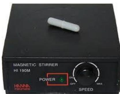
Un agitateur magnétique est un appareil électrique. Celui-ci est constitué d'un bloc qui contient un aimant, surmonté d'une plaque. Grâce à un moteur, l'aimant est mis en rotation. Une molette située sur le devant de l'agitateur permet d'ajuster manuellement la vitesse de rotation de l'aimant.
